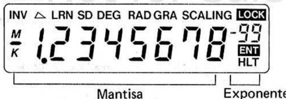
La pantalla visualiza los datos de entrada, y los resultados parciales y finales de las operaciones. La porción de la mantisa acepta hasta 8 dígitos. La sección exponencial tiene dos dígitos ( $\pm 99$ ).
