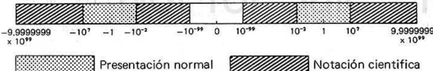
Cuando la respuesta excede la capacidad normal de presentación, ésta se muestra automáticamente por notación científica, mantisa de 8 dígitos y exponente de 10 hasta  $\pm 99$ .
